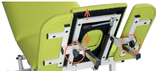
Podhlavník se nastavuje do určité polohy nadzvednutím a přidržení pákového mechanismu. Po uvolnění se podhlavník zablokuje v této poloze. Postranice podhlavníku se spouští tím, že povolíme okřídlený šroub, postranici sesuneme do požadované polohy a šroub utáhneme.
